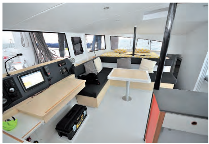
La conception du roof est habile, l'inclinaison négative des pare-brise protège des UV, évite la surchauffe, et leur conception simple permettra un remplacement rationnel le moment venu.
